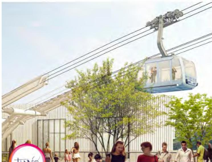
Pourvu de 3 câbles (deux porteurs et un tracteur), ce système allie performance et confort pour l'utilisateur et les riverains.
