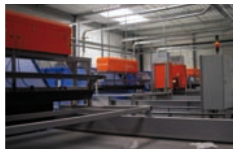
Tri optique au centre de tri automatisé des déchets d'activités économiques. © Semardel
